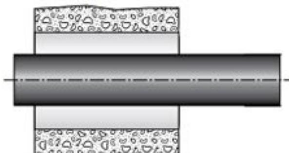
Jádrové vrtání/ pažnice zbabte nerovnosti a nečistot. Očistěte procházející kabel/potrubí. Zkontrolujte rozměry jádrového vrtání/pažnice a procházejícího kabelu/potrubí.
